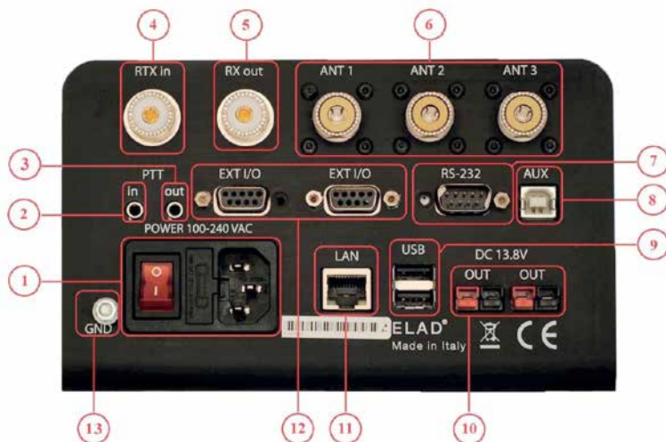
Rys. 1. Złącza na tylnym panelu wzmacniacza
